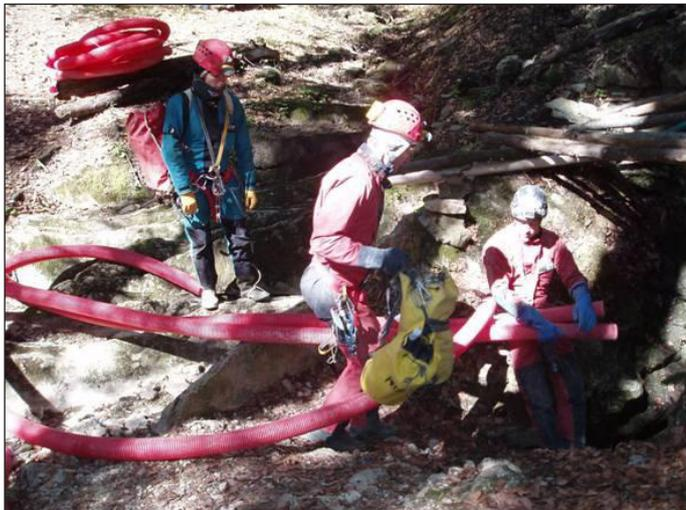
Chaque chantier est équipé d'un extracteur de gaz, d'une certaine longueur de janolène, et d'un pollumètre avec une feuille de relevés pour « voir » l'extraction du nuage de gaz. Nous avons également quelques Draggers pour notre sécurité et pour confirmer la fin des extractions.
