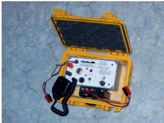
Photo 1 : Système Nicola, système de transmission par le sol
